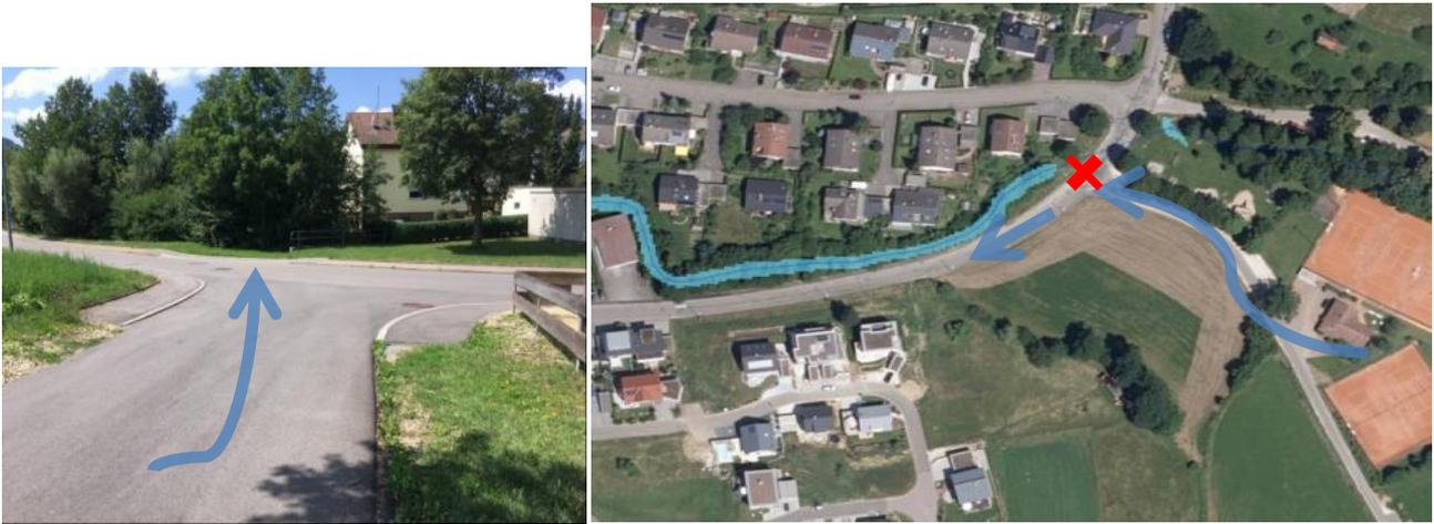
**Abbildung 19:** Durch Absenkung des Bordsteins fließt der aus dem Außengebiet kommende Oberflächenabfluss an der Kreuzung direkt ins Gewässer (links) anstatt entlang der Straße in Richtung Westen in das Siedlungsgebiet (rechts) [LRA Ostalbkreis]
