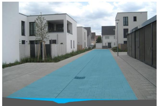
**Abbildung 12:** Umgekehrtes Dachprofil zur Zwischenspeicherung und Ableitung von Straßenabflüssen bei Starkregen [Stadt Karlsruhe, Tiefbauamt]
