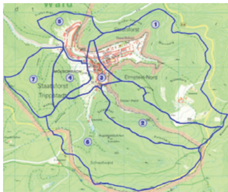
Abb. 8: Topographische Karte des Gesamteinzugsgebiets von Kaiserslautern-Mölschbach mit Teileinzugsgebieten
